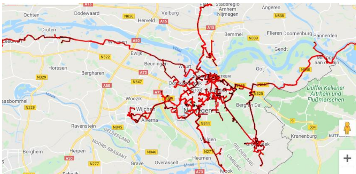
Fig 1 De totale infrastructuur van TeleMANN eind 2022. De lengte van alle rode lijnen (basisinfrastructuur en aansluitingen) samen bedraagt 246 km.
