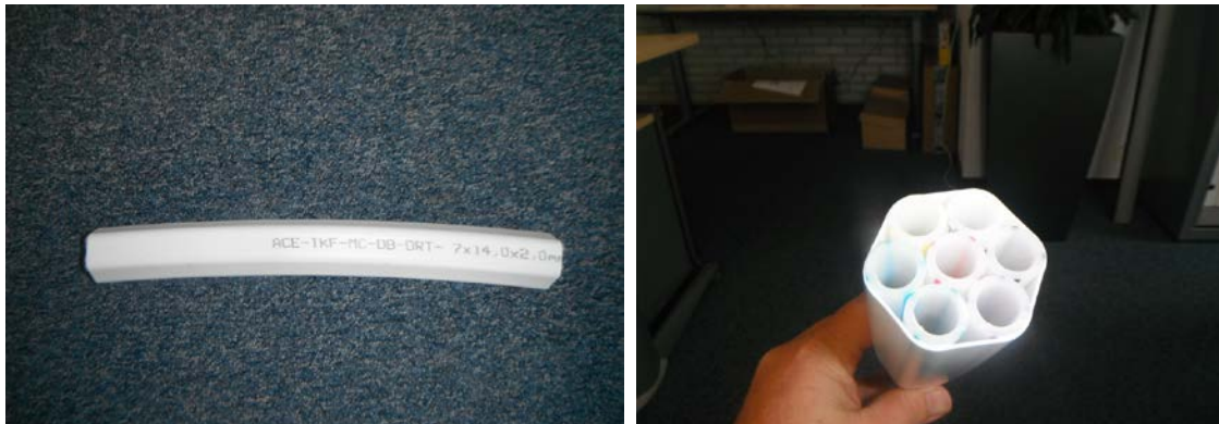
Fig 6 De nieuwe DB7 mantelbuis met 7 afzonderlijke buizen die elk een glasvezelkabel kunnen bevatten met een capaciteit van maximaal 192 glasvezels per kabel.
