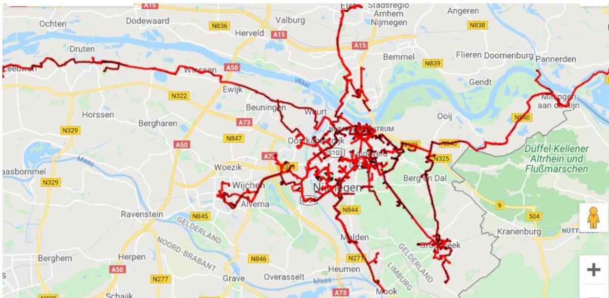
Fig 2 De totale infrastructuur van TeleMANN eind 2021. De lengte van alle rode lijnen (basisinfrastructuur en aansluitingen) samen bedraagt 244 km.
